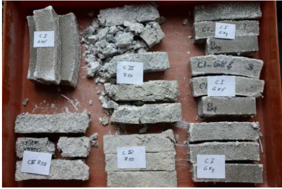
Die im Jahr 2012 aufgrund massiver Gefügezerstörungen ausgeschiedenen Mörtelprüfkörper von 7 verschiedenen Rezepturen
