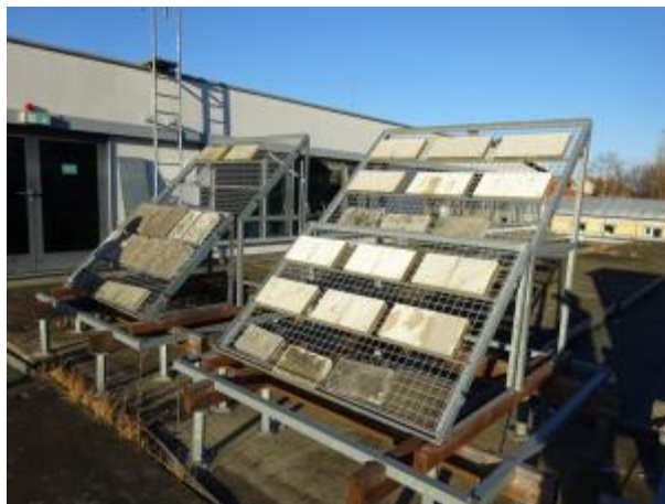
Bewitterungsstand auf dem Dach der FH Erfurt
